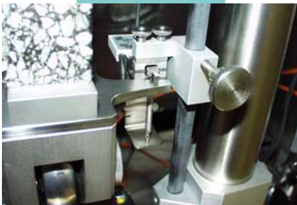
Detailansicht eines Wegaufnehmers Detailed view of one displacement transducer
